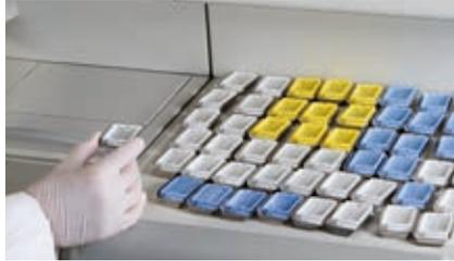
Die Kühlplatte mit ihrer großzügigen Arbeitsfläche verfügt über Platz für bis zu 65 Kassetten. Da Kühleffizienz besonders wichtig ist, verfügt die Kühlplatte über ein **sich an die Umgebung und Standardlaborbedingungen anpassendes Kontrollmodul**, das die Betriebstemperatur stets **stabil auf -6 °C** hält.
