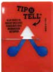
Kippindikatoren überwachen, ob die Sendung nach Ihren Anforderungen aufrecht befördert und gelagert wurde. Ab einer Neigung von 60° fließt blauer Quarzsand in das pfeilförmige Anzeigefenster und bleibt dort haften. Die unsachgemäße Behandlung der Sendung ist dadurch sofort sichtbar und unstrittig nachweisbar.
