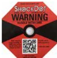
Im Shockwatch-System werden Schläge oder Stöße, die über einer vorgegebenen Stärke liegen, durch Rotfärbung angezeigt. Bei Überschreitung einer definierten Beschleunigung (g-Wert) kommt es zu einem Farbwechsel des Indikatorröhrchens.
