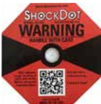
Dans le système Shockwatch, le point de choc indique par une coloration en rouge les impacts ou les chocs qui dépassent une intensité spécifiée. Le dépassement d'une accélération définie (valeur g) entraîne un changement de couleur du tube indicateur.
