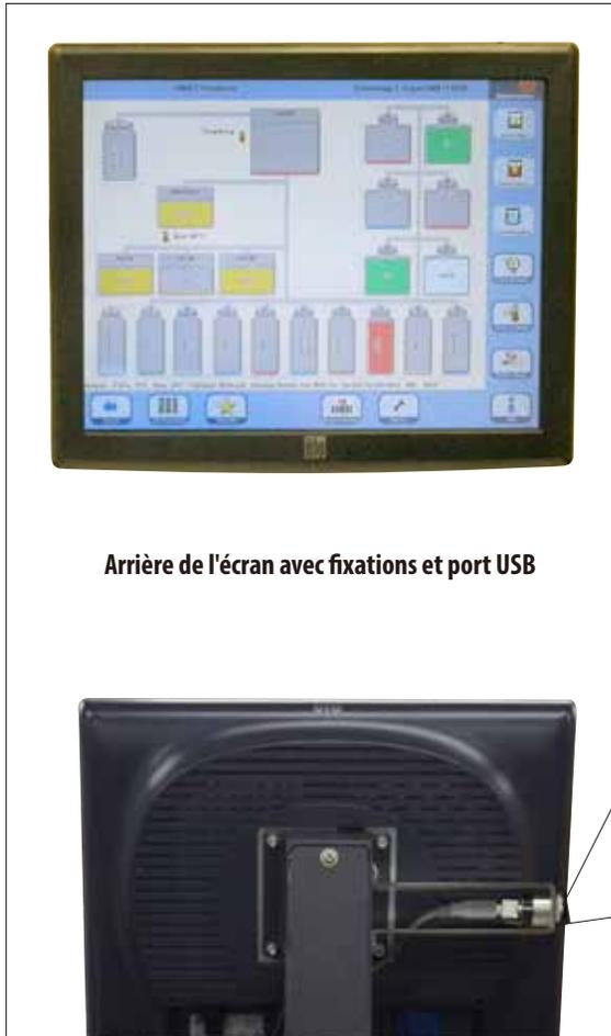
Arrière de l'écran avec fixations et port USB
