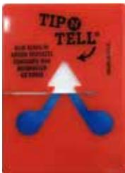
L'indicateur Tip-n-Tell permet de surveiller si l'expédition a été transportée et stockée dans la position verticale, conformément à vos exigences. Avec une inclinaison de 60° ou plus, le sable de quartz bleu passe dans la fenêtre de l'indicateur en forme de flèche et reste collé à cet endroit en permanence. Une mauvaise manipulation de l'expédition est immédiatement détectable et peut être prouvée de manière incontestable.
