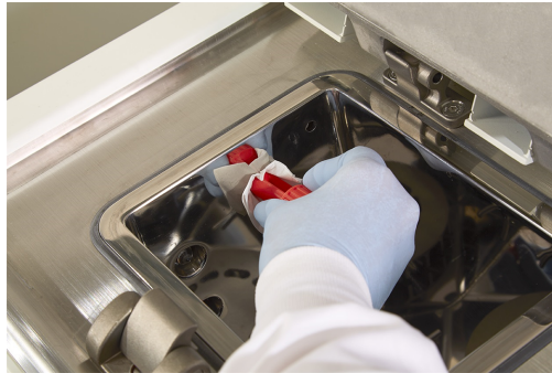
Figura 7-4: Utilizzo dello strumento di pulizia degli LLS
