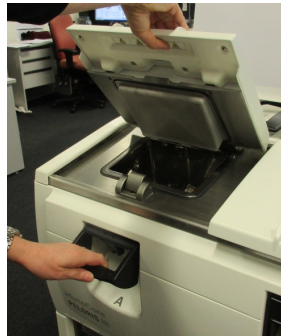
Figura 2-3: Apertura del coperchio di una storta
