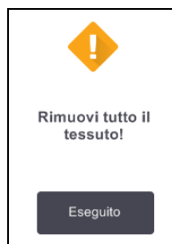
Figura 3-2: Non toccare Eseguito finché dalla storta non sono stati rimossi tutti i cestelli.
