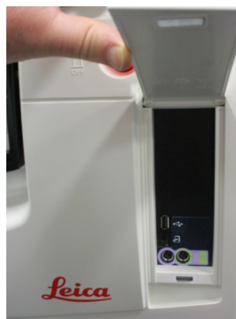
Figura 2-19: Porta USB anteriore, dietro l'aletta
