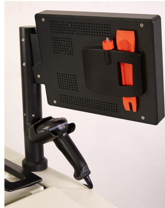
Figura 7-1: Ubicazione degli strumenti di pulizia
