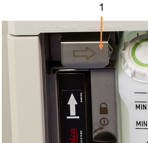
Rysunek 5-11: Klapka zdalnego napełniania/opróźniania otwiera się na przewód odczynnika (po lewej) i przewód odpadów parafinowych (po prawej).
