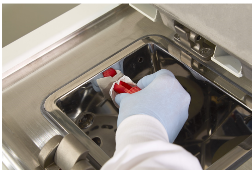
Рис. 7-4: Использование инструмента для очистки датчиков уровня жидкости
