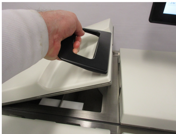
Рис. 2-13: Открытие крышки парафиновой ванны
