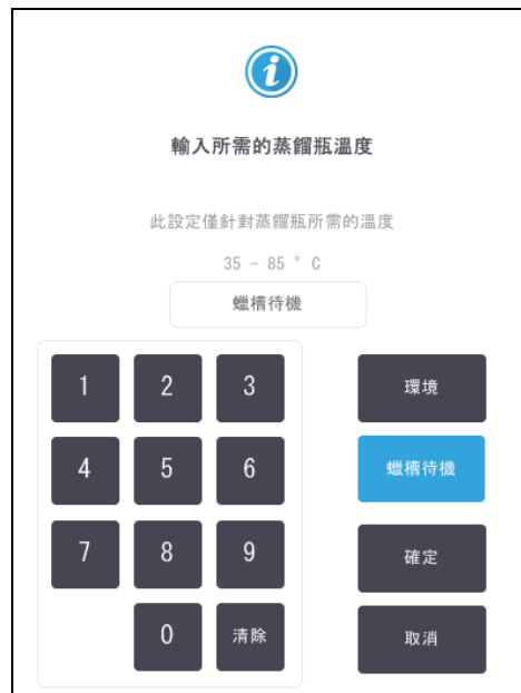
Figure 6-2: 將蒸餾瓶溫度設為蠟槽待機溫度
