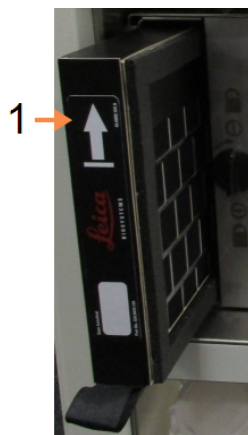
Figură 7-12: Înlocuirea filtrului de carbon cu săgeata de direcție (1) orientată în sus
