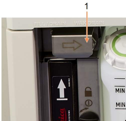
Figură 5-11: Clapetă de umplere/golire din container exterior deschisă cu conducta de reactiv (stânga) și conducta de deșeurii de ceară (dreapta)
