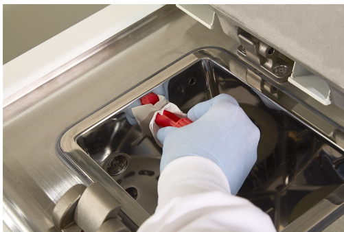
Figură 7-4: Utilizarea instrumentului de curățare LLS
