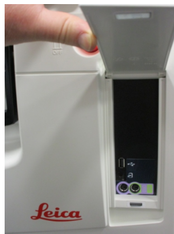
Фигура 2-19: Преден USB порт, зад капака
