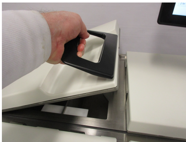
Фигура 2-13: Отваряне на капак на восъчна баня
