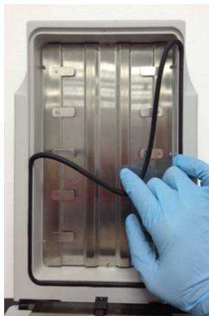
Remoção da junta da
