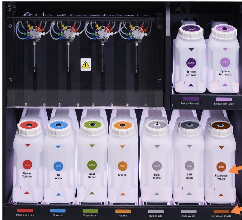
Vérifiez que l'étiquette et la couleur du bouchon de chaque récipient en vrac et la description imprimée correspondent à l'étiquette sur la cavité de l'instrument,
