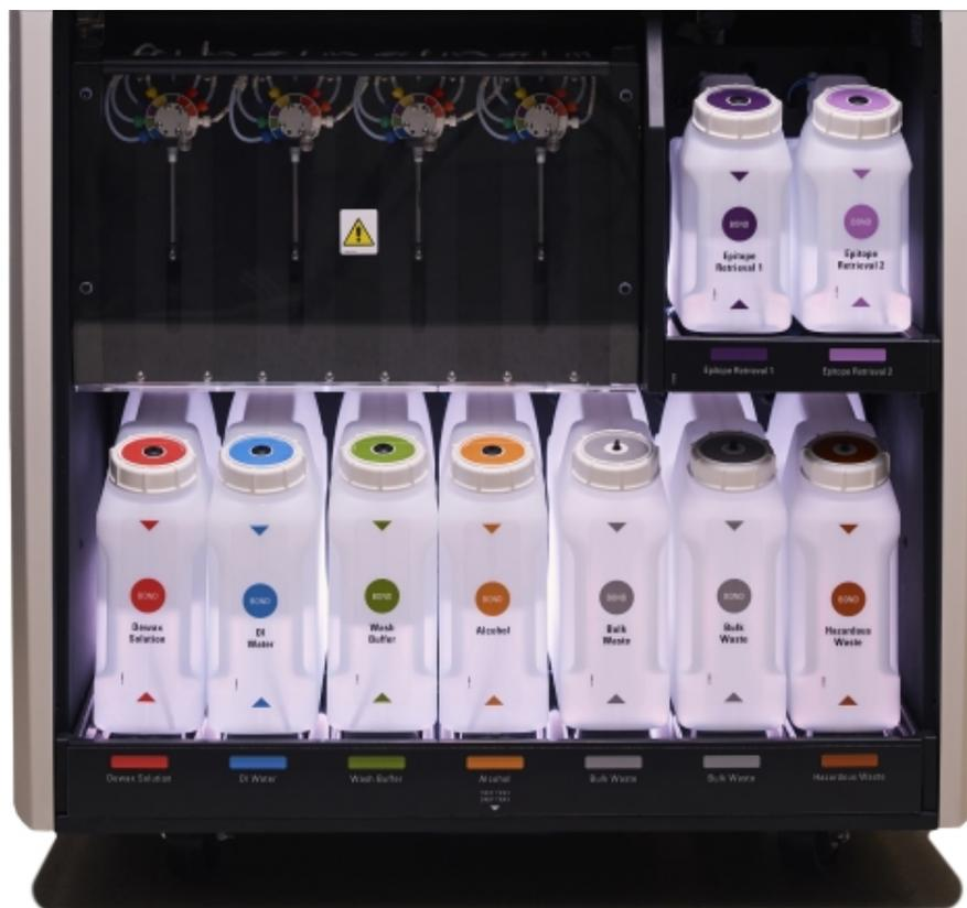
Le système d'éclairage du récipient en vrac permet de voir le niveau de liquide dans chaque récipient, et les lampes blanches statiques pendant l'opération normale.
