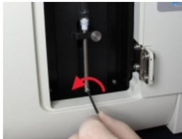
Certains modèles ont une vis à serrage manuel au lieu d'une vis à tête hexagonale.
