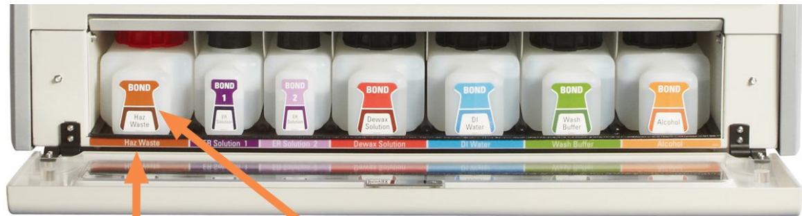
Ábra 2-16: A BOND-MAX nagy folyadéktérfogatú reagensek a helyükre illesztve
