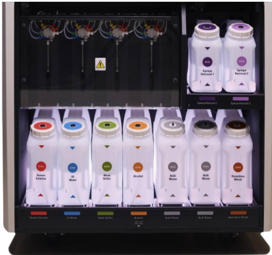
Ábra 2-15: Nagy folyadéktérfogatú tartály világítórendszer
