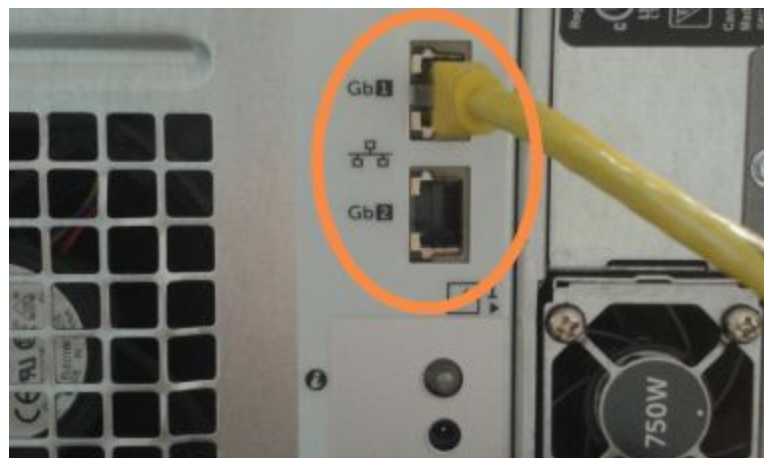
Ábra 16-5: A LIS-hez használt Ethernet portok
