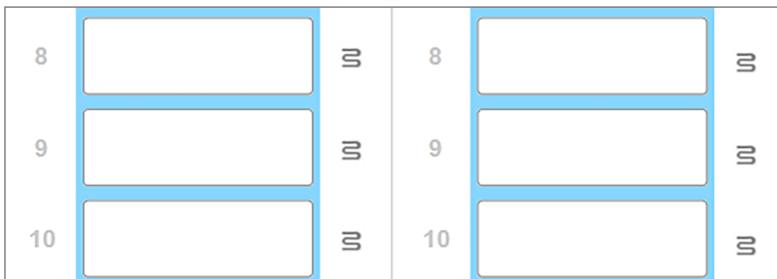
Ábra 5-4: Az egyes pozíciókban a szürke hevítő-szimbólumok a hevítés teljes leállítását jelzik
