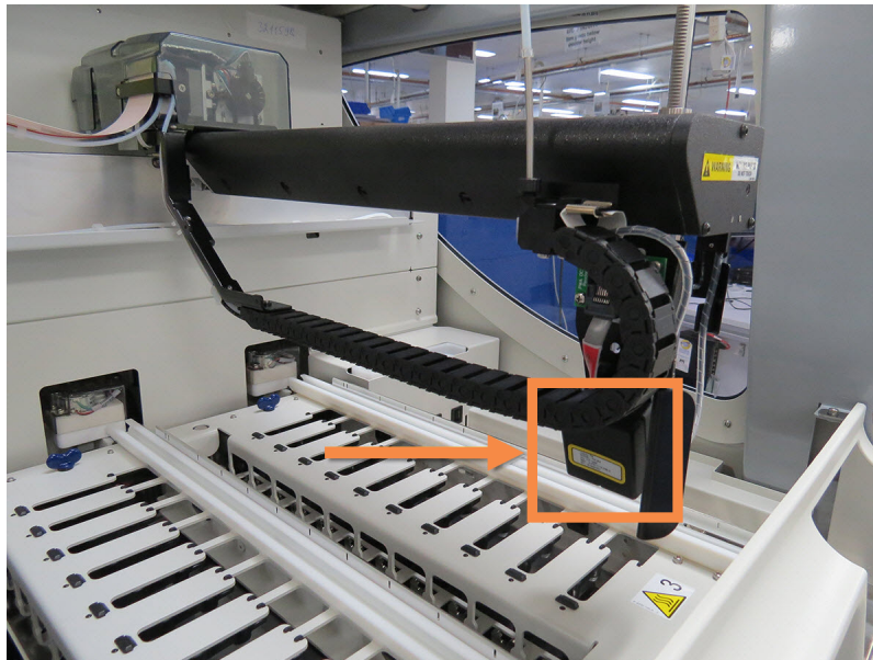
Ábra 2-6: A fő robotról készült kép, nyíl jelzi az azonosító-képolvasót
