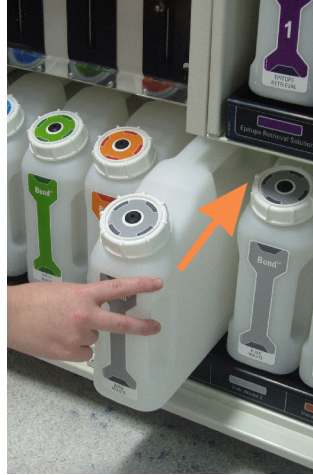
그림 12-1: 폐기물 컨테이너를 다시 제자리에 설치
