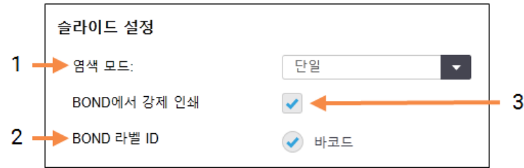
그림 10-9: 케이스 및 슬라이드 설정 구획에서 슬라이드 설정
