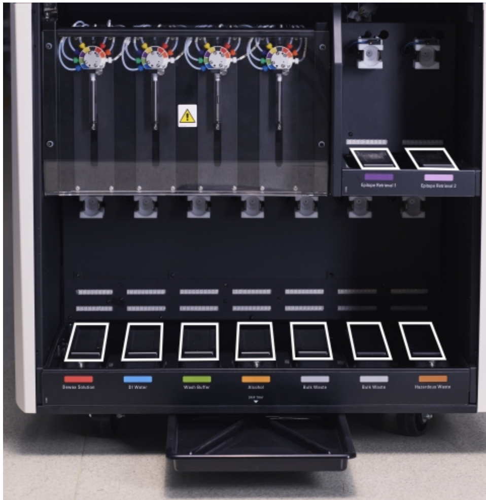
그림 12-13: BOND-III 벌크 용기 드립 트레이 및 무게 센서 커버
