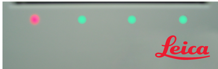
그림 2-13: BOND-MAX 처리 모듈의 시약 트레이 LED 색상(빨간색, 녹색)
