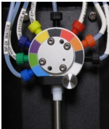
Slika 2-23: Injekcijska brizga z 9 vhodi BOND-MAX
