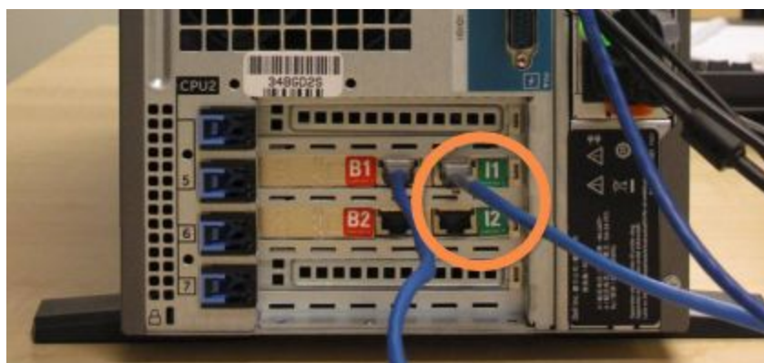
Slika 16-3: Vhodi modula za obdelavo krmilnika
