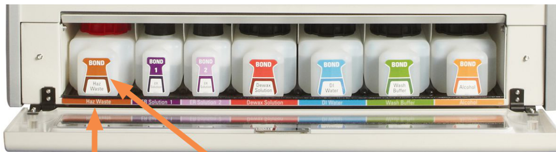
Slika 2-16: BOND-MAX reagenti v večjih količinah na položaju
