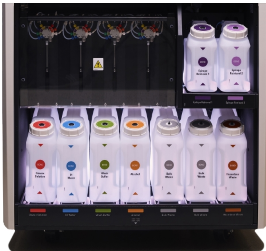
Slika 2-15: Sistem razsvetljave vsebnika za večje količine
