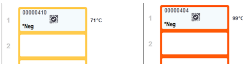
Figur 5-6: Temperaturindikation på preparatbrickan: varm (vänster) och het (höger)
