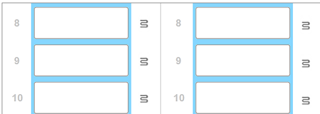
Figur 5-4: Grå värmarsymboler för varje position anger att hela uppvärmningssystemet är avstängt
