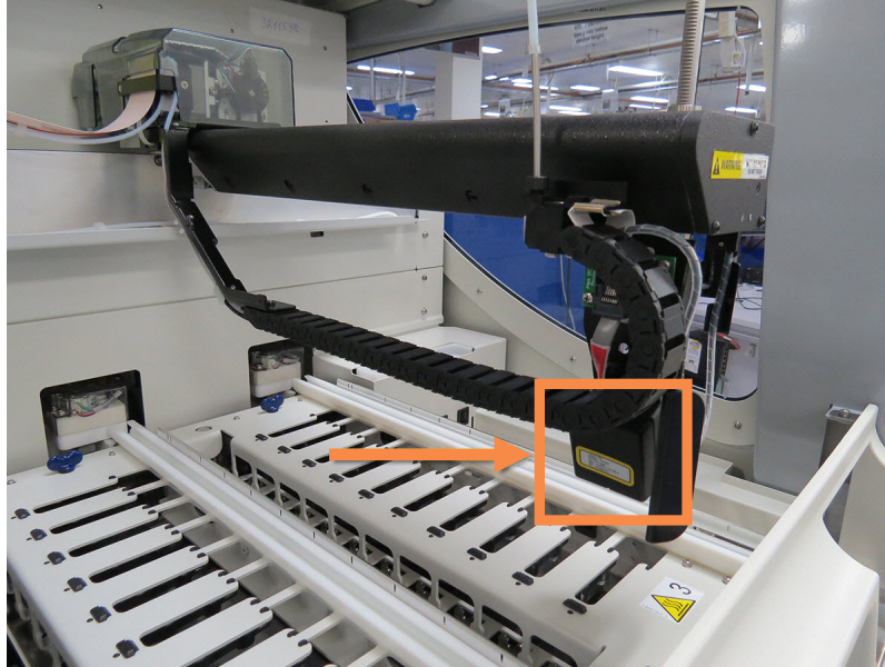
Figur 2-6: Foto av huvudroboten med ID-avbildaren markerad med pilen
