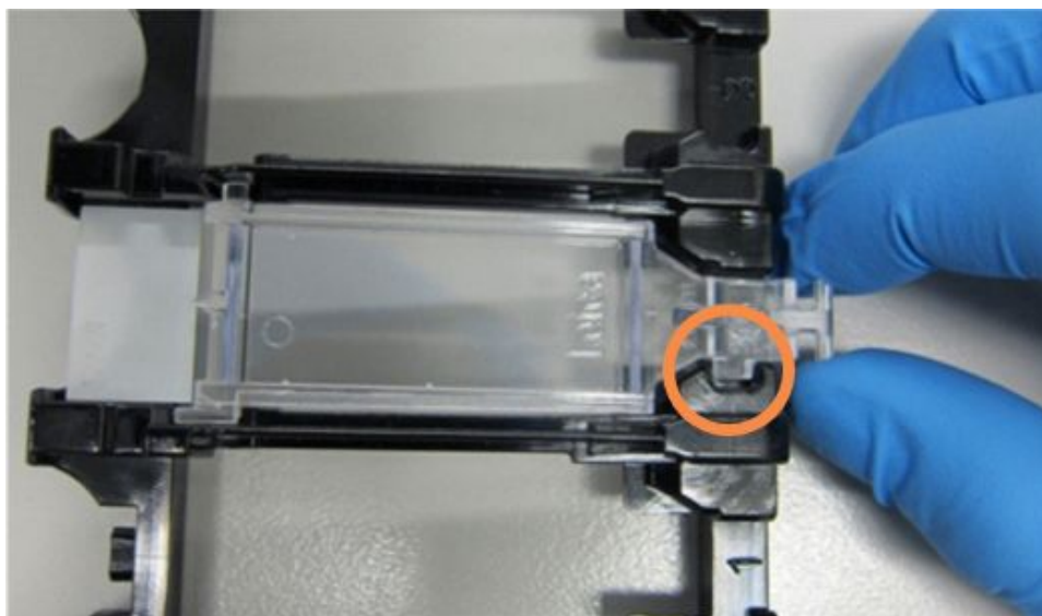
Obrázok 4-6: Umiestnenie krycieho sklíčka Covertile na podložné sklíčko
