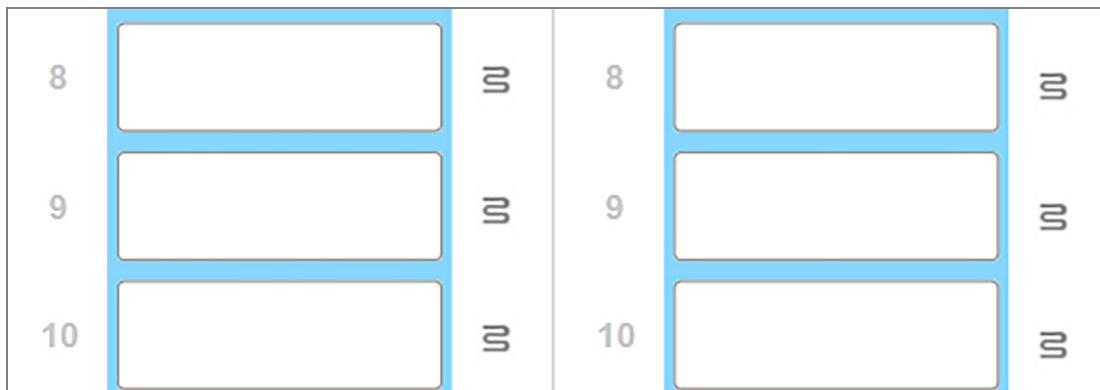
Obrázok 5-4: Sivé symboly ohrievača v každej polohe označujú úplné vypnutie vyhrievania
