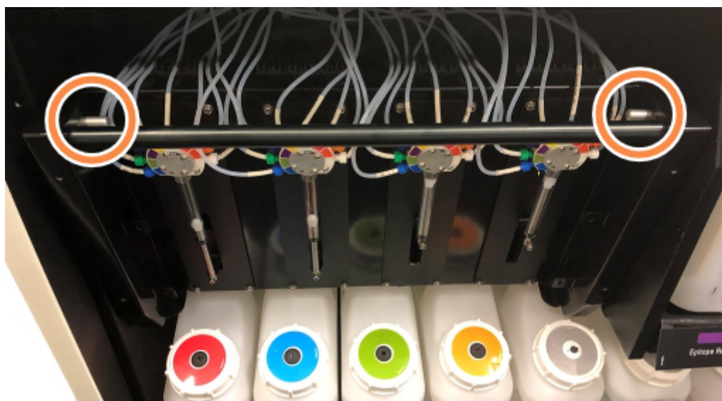
joonis 12-9: Vabastustihvtide asukoht avatud seadmel
