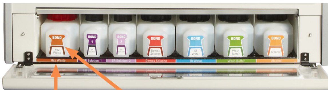
joonis 2-16: BOND-MAX põhianerektiivid õiges asendis
