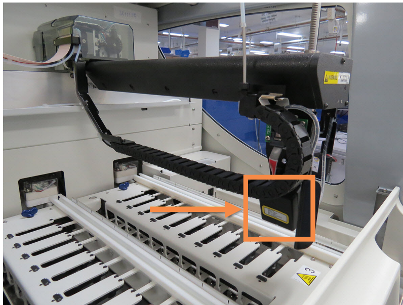
joonis 2-6: Foto põhirobotist koos noolega tähistatud ID-pildistajaga
