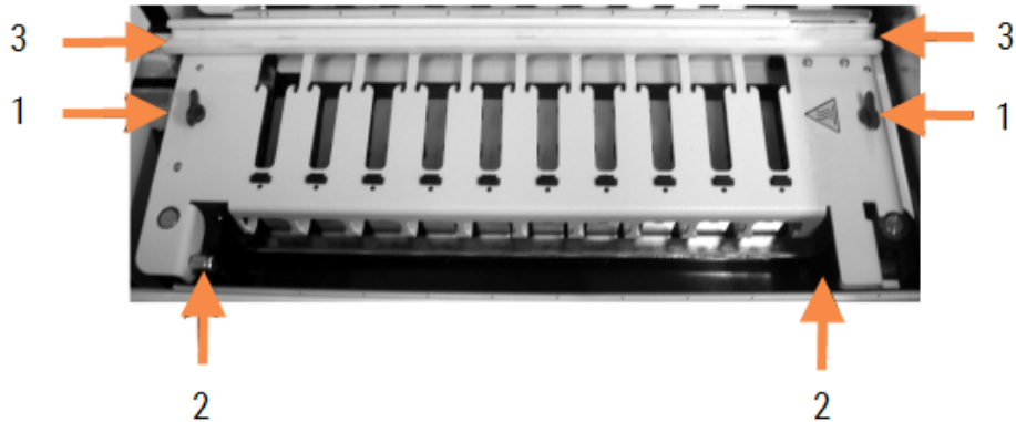
joonis 12-6: BOND-III ülemine plaat
