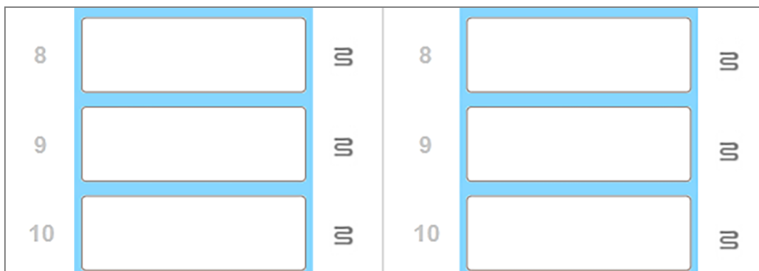
Hình 2-8: Biểu tượng bộ gia nhiệt màu xám ở mỗi vị trí biểu thị tắt hoàn toàn hệ thống gia nhiệt
