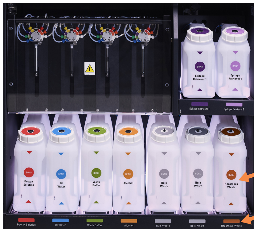
Hình 2-14: thùng chứa thuốc thử số lượng lớn ở vị trí BOND-III
