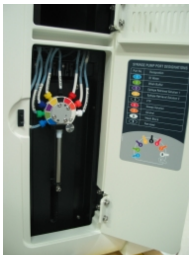
Hình 2-5: Ống tiêm phía sau cánh cửa có bản lề
