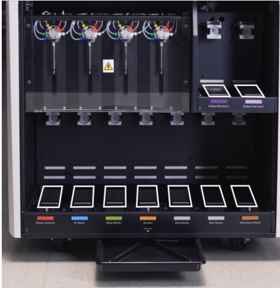
Hình 12-13: Khay nhỏ giọt của thùng chứa số lượng lớn BOND-III hiển thị các nắp cảm biến trọng lượng
