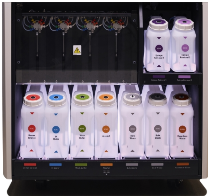
Hình 2-15: Hệ thống chiếu sáng thùng chứa số lượng lớn
